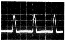
26. IC601 Pin 21 (E-PCB) 4.8V, 20 \mu s / Div
