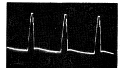
10. FBT Pin 4 (E-PCB) 220V, 20 \mu s / Div
